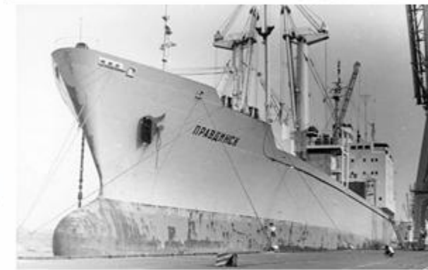
Универсальное судно типа «Варнемонде» емкостью 10997 брт. или 368 TEU
