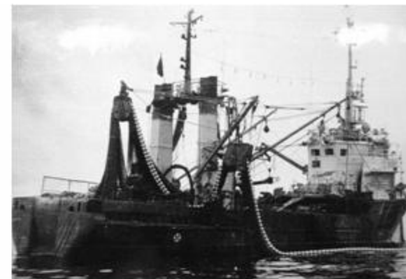
Средний рыболовный траулер- морозильщик типа «Надежный»
